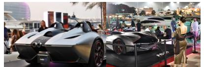
F61H は圧縮水素を燃料とし、12気筒独立電子制御水素燃料噴射システムを採用した水素燃料自動車です。イタリア製V型12気筒ガソリンエンジンをベースとしてパートナー企業の株式会社FLAT FIELD(\*2)と共に開発を進めたもので、ガソリンエンジンにも劣らないパフォーマンスとエグゾーストノートを含む、官能的なサウンドを楽しめます。トランスクルスルレイアウトの6速マニュアルトランスミッションが採用され、リアに水素燃料タンクが装着されています。また、現在の標準的な水素ステーションにて水素燃料の充填が可能です。
